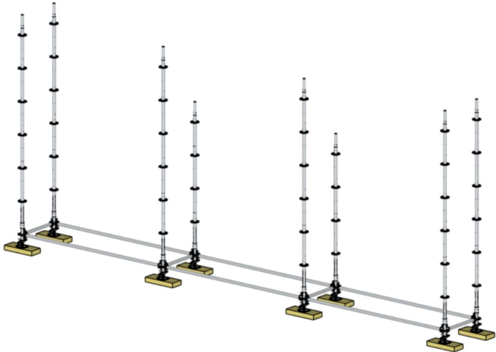
Continuer le montage en plaçant les lisses longitudinales et transversales.
