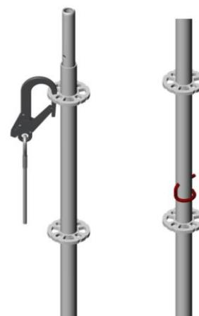
Positions approuvées pour sécurisation sur les rosaces pour les plateformes d'une largeur  $\geq 1,50\text{m}$  (cerclées de rouge)
